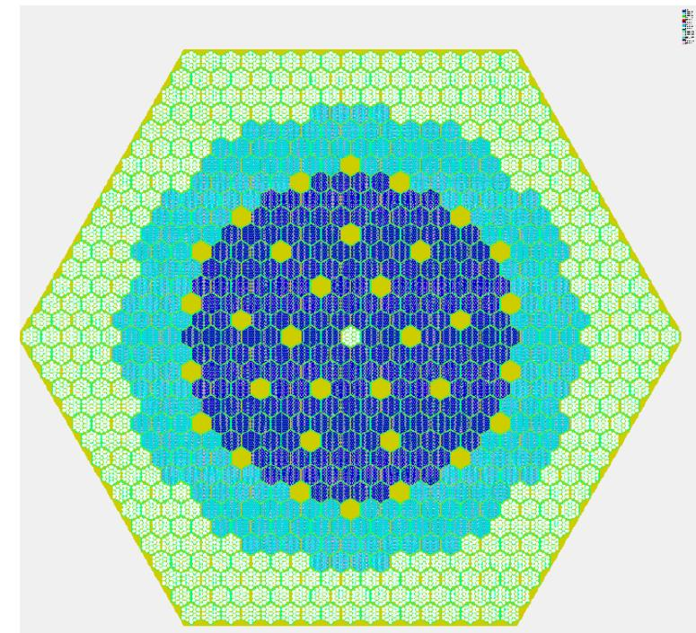
Figura 5. Corte radial del núcleo a la altura activa
